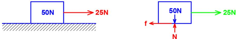
[解]：自由體圖得知，平衡狀態下  $N=50\text{N}$   $f=25\text{N}$
